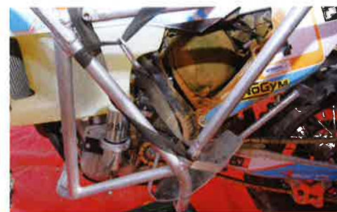
ETRIER : Voici les "footstraps" dans lesquels Nicola enclenche ses bottes. Les roll bars sont là pour le protéger en cas de chute et un baquet le maintient en selle... même en cas de chute. Risqué.
